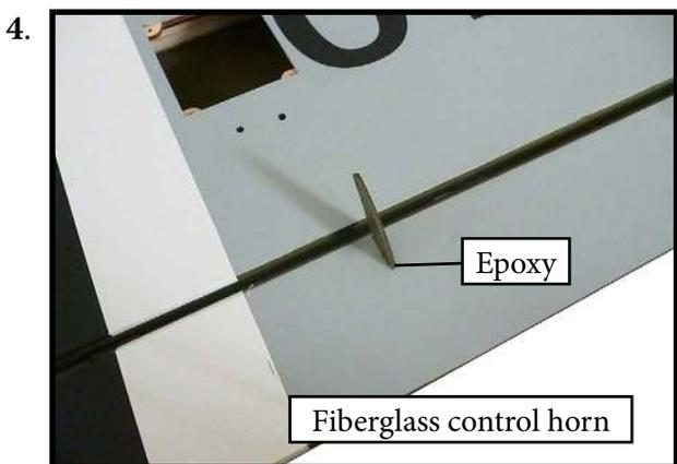
**INSTALLING THE AILERON SERVOS**
