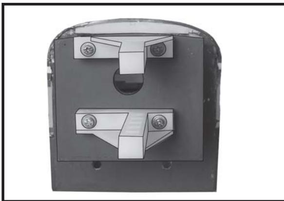
**INSTALLING THE STOPPER ASSEMBLY.**
