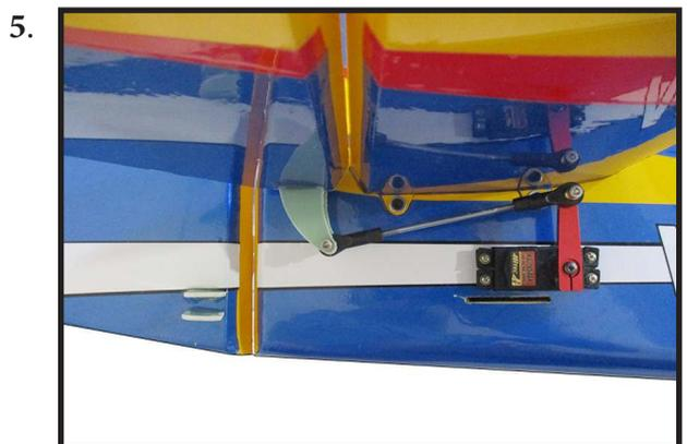
**INSTALL RUDDER CABLE AND SERVO**
