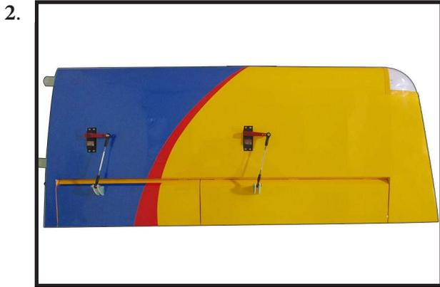
**INSTALL HINGE FOR STABILIZER AND ELEVATOR**
