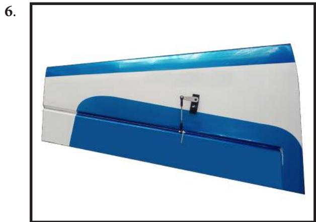
**INSTALL HINGE FOR STABILIZER AND ELEVATOR**
