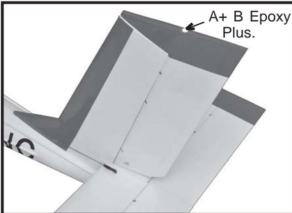
**RUDDER CONTROL HORN INSTALLATION.**
