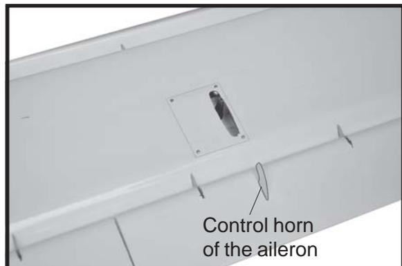
**3. INSTALLING THE AILERON LINKAGES .**
